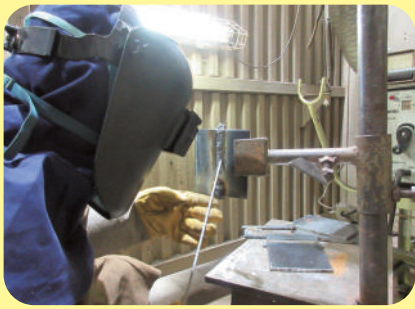
Soldadura electrodo revestido
