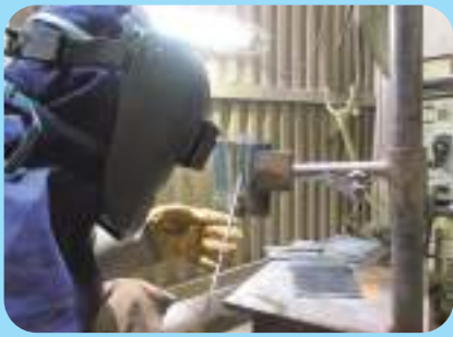
Soldadura electrodo revestido
