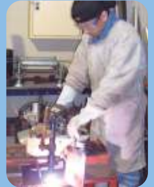
プラズマ切断
