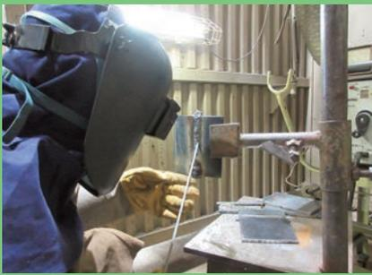
Soldagem eletrodo revestido
