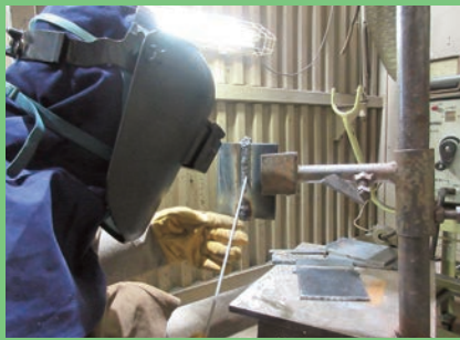
被覆アーク溶接
