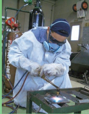
ガス切断・溶接
