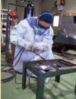
ガス切断・溶接
