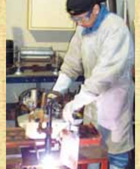
プラズマ切断
