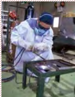
ガス切断・溶接
