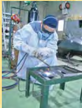
ガス切断・溶接
