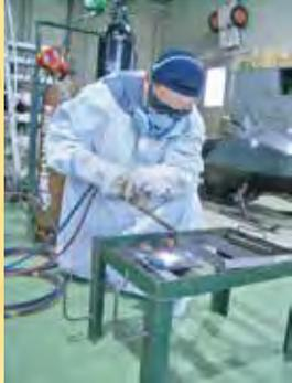
**soldadura y corte a gas**
